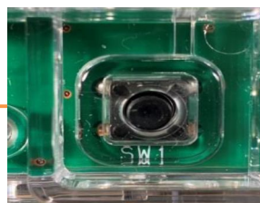
電源基板 電源スイッチ
